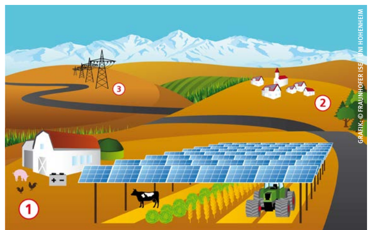
1 Technischer Eigenverbrauch zukünftig mit Energiespeicher 2 Direktvermarktung an nahe- liegende Wohnsiedlung 3 Energieeinspeisung ins Strom- und Gasnetz
