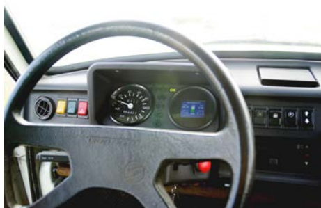
Neu im Cockpit: roter Not-Aus-Knopf, Digitaldisplay und Pfeil-Kippschalter
