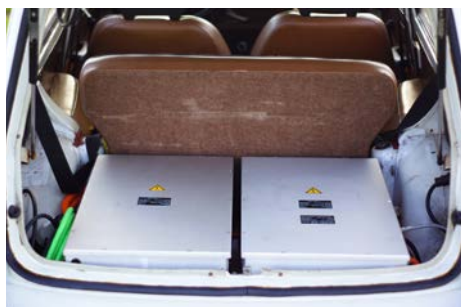
Neu im Kofferraum: zwei große Lithium-Batterie-Kästen
