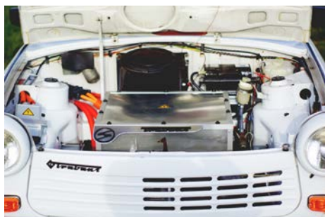
Neu im Motorraum: Alukiste „Marke Einbau“ als E-Motor-Halterung u. v. m.
