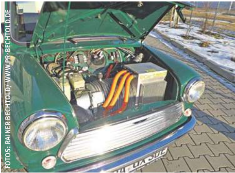
Unter der Haube arbeitet der E-Motor direkt auf dem Getriebe
