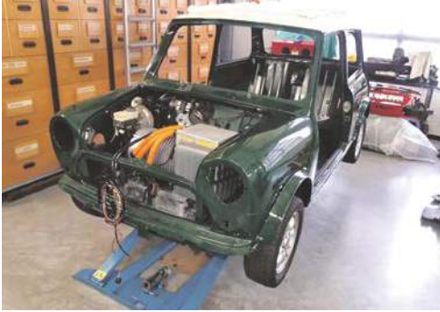
Kompletter Umbau vom alten Mini zum neuen E-Mini
