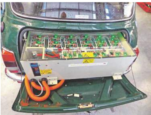
Batterie und Ladeelektronik passen genau in den Kofferraum
