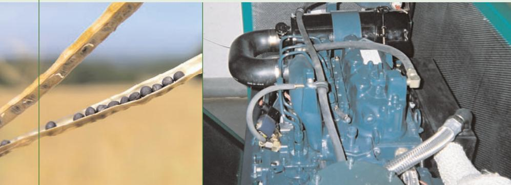
Seitdem produziert im Keller des Internationalen Katholischen Missionswerkes „missio“ in Aachen ein Rapsöl betriebenes 3-Zylinder-BHKW Strom und Wärme. Bisher erzeugte es fast 150.000 kWh Strom und etwa die doppelte Menge Wärme. Die elektrische Leistung des BHKW beträgt 8 kW und die Wärmeleistung etwa 16 kW. Die Wärme dient der Beheizung und Warmwasserversorgung des missio-Gebäudes.
