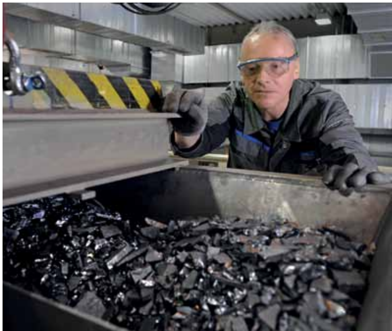
Silizium aus eigener Produktion wird einem internen Recyclingkreislauf zugeführt und zur Wiederverwertung in der Waferherstellung aufbereitet.
