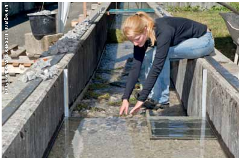
Studentin Andrea Melzer baut das Modell eines Fischeaufstiegs, der mit dem Schachtkraftwerk kombiniert wird.
