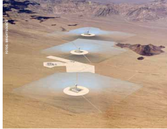
Auf einer Fläche von ca. 1.450 ha ist das Projekt Ivanpah Solar Electric Generating System (ISEGS) in Südkalifornien ein solarthermisches Kraftwerk mit rund 392 Megawatt Kapazität; 2013 soll es fertiggestellt sein und dann über 140.000 Haushalten solaren Strom liefern
