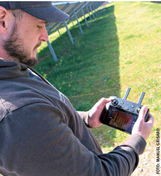
Drohnen-Pilot Moritz Seibt: Auf seinem Controller sind die Thermografieaufnahmen in Echtzeit zu sehen. Hier zeigt das Thermografiebild zwei defekte Substrings
